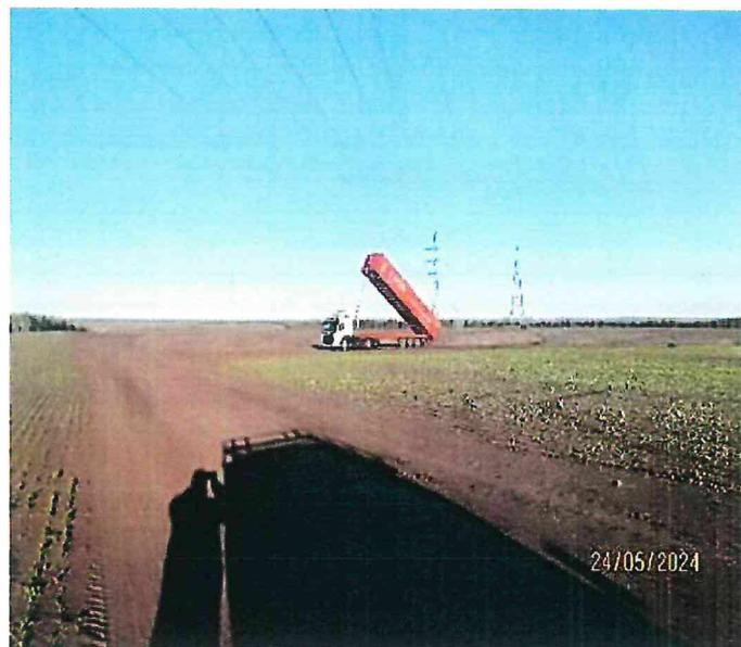
Несчастный случай при производстве несанкционированных работ в охранной зоне ВЛ-110 кВ с применением крана-манипулятора. Водитель получил тяжелую электротравму.
